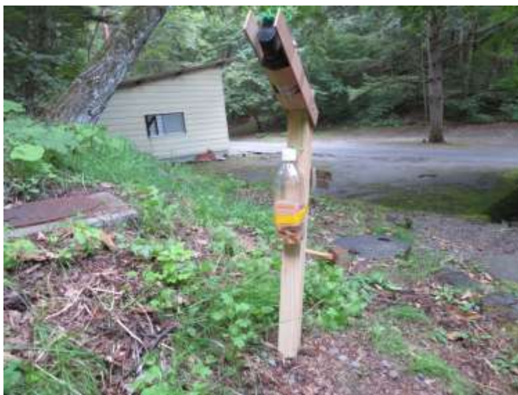
写真1. クマが餌を引っ張ると唐辛子エキスがスプレーされる
